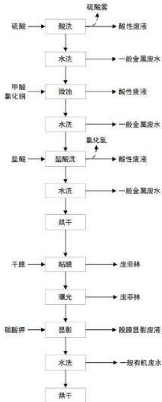
图2-11 外层图形制作工艺流程及产污节点图
