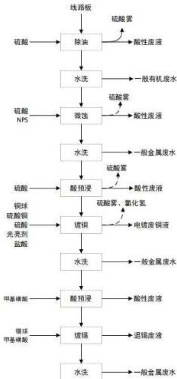
图2-12 图形电镀生产工艺流程及产污节点图
