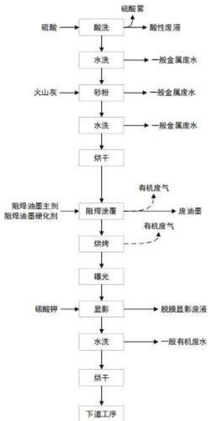
图2-14 阻焊工段生产工艺流程及产污节点图
