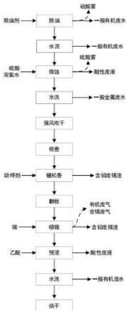
图2-16 喷锡工段生产工艺流程及产污节点图
