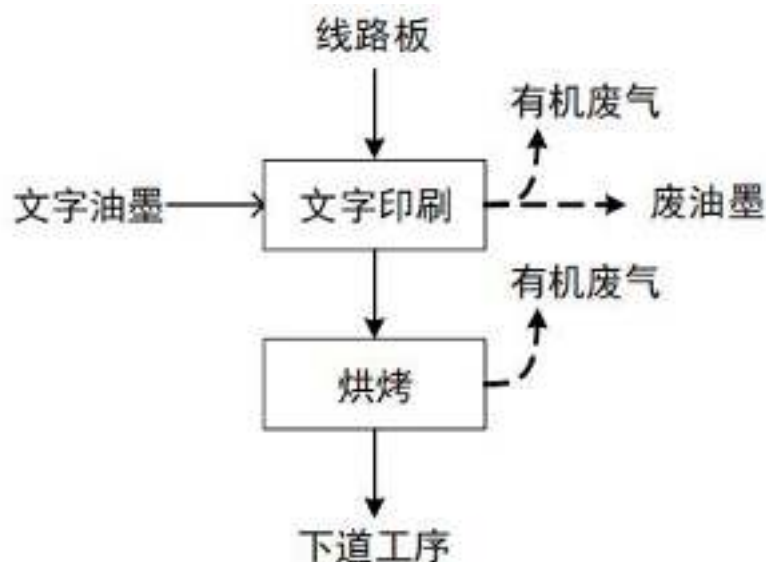
图2-15 文字工段生产工艺流程及产污节点图
