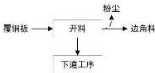
图2-3 开料工序工艺流程及产污节点图
