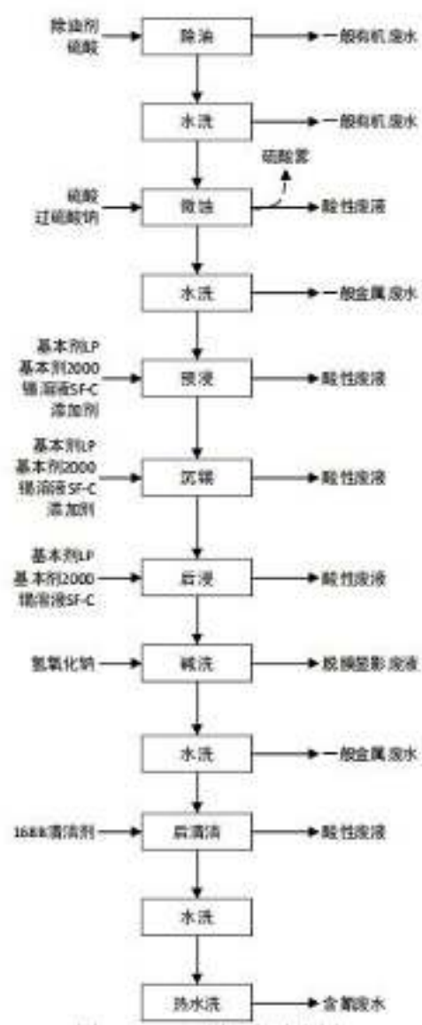
图2-21 沉锡工艺流程及产污节点图
