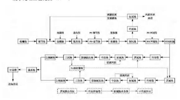
图 2.5.1-1 废水处理工艺流程图
