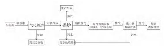
图 2.5.2-1 废气处理工艺流程图
