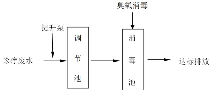
图 5 项目污水处理工艺流程图
