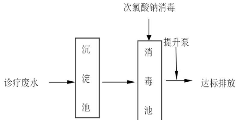
图 4 项目污水处理工艺流程图
